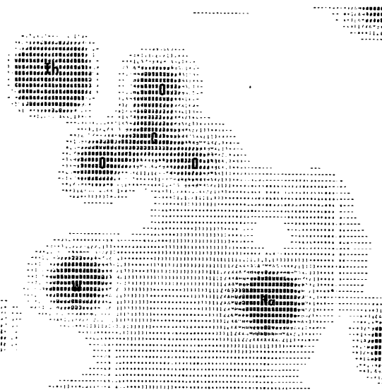
Fig. 2. Section de la densité électronique au niveau z = \frac{7}{32} mettant en évidence le groupe carbonate au voisinage du thorium.
